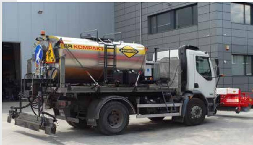
Die verfügbaren Tankvolumen betragen 2000, 4000, 6000 und 8000 Liter. Die Spritzmaschine kann an den Fahrgestellrahmen, auf einen Ladekasten, auf dem Rahmen eines Abrollkippers oder auf einen Anhänger montiert werden.
